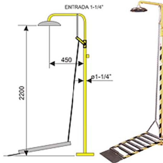
ESTRUCTURA CONSTRUIDA EN CAÑO DE ACERO GALVANIZADO REVESTIDO CON PINTURA EPOXI COLOR AMARILLO.
